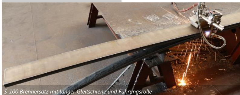
EPOCH Brennersatz mit Führungsschiene für schwere Beanspruchung
