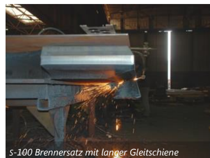
S-100 mit langer Gleitschiene und Fasenschneid-Aufsatzoption
